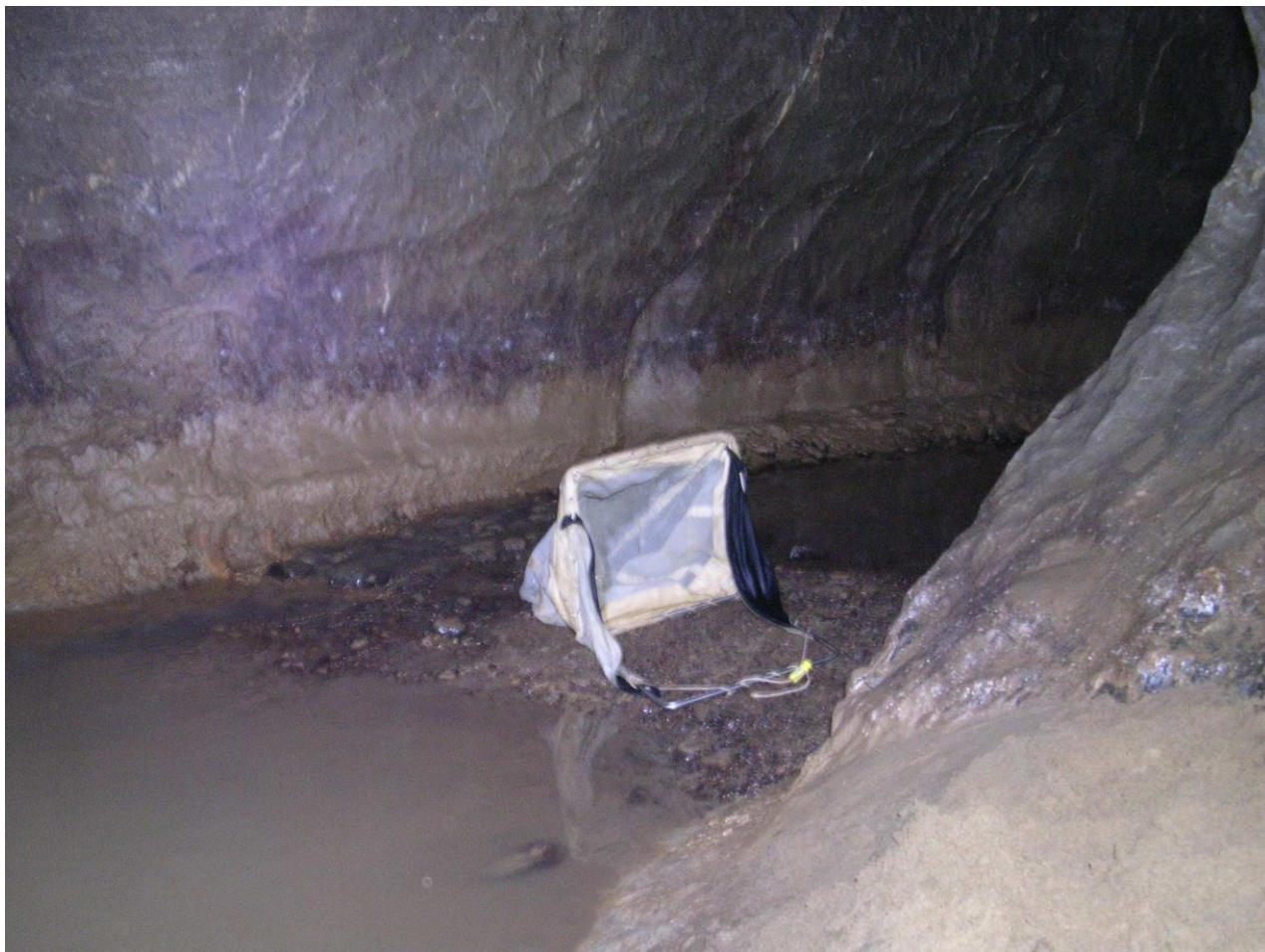
Fotografía 1. Red Surber para muestreo de fauna acuática subterránea en una de las cuevas del karst.
